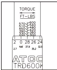
3. Continúe girando el MANGO si el valor de torsión deseado se encuentra entre los números primarios de la ESCALA PRINCIPAL. Sume el número secundario de la ESCALA DEL CARTUCHO al número primario de la ESCALA PRINCIPAL para obtener el valor de torsión deseado.
