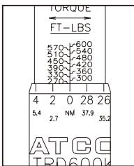
2. Gire el MANGO o EJE hasta que el "0" en la ESCALA DEL CARTUCHO alcance el número primario del valor de torsión deseado en la ESCALA PRINCIPAL.
